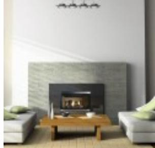
**Summary** Chimenea Estanca de 91 cm. de anchura. Ventilación trasera. Funcionamiento a Gas Propano/Butano, potencia máxima de hasta 5,3Kw - 4540 Kcal/hr. Encendido electrónico.
